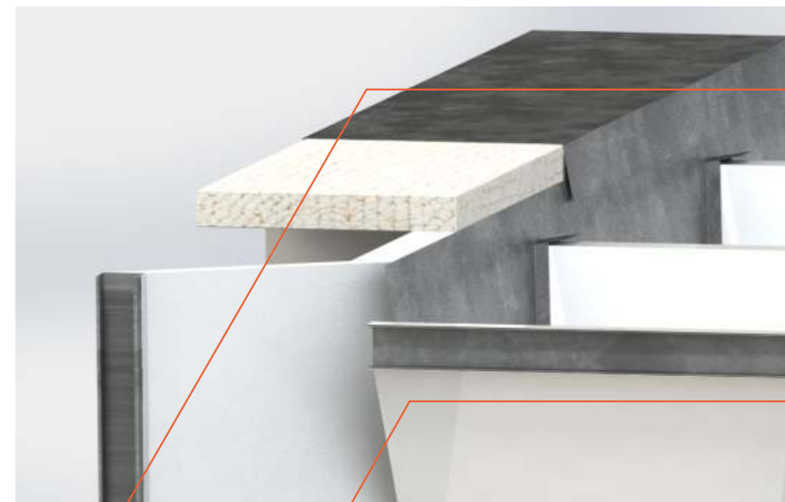
3- Colocación de la Placa de EPS por encima del panel de cerramiento y por debajo de la cenefa de cubierta.
