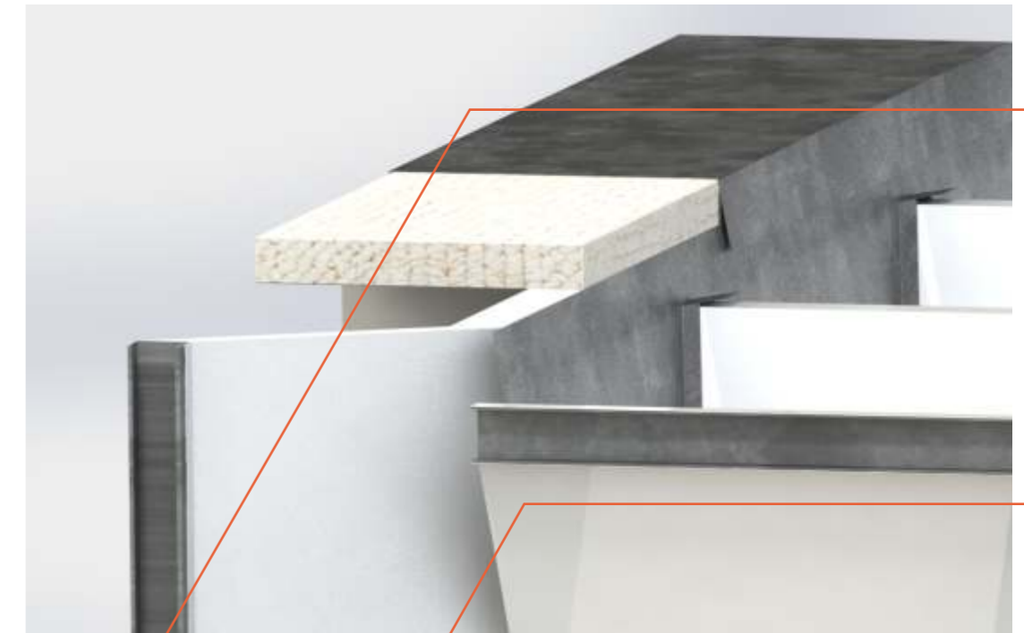
3- Colocación de la Placa de EPS por encima del panel de cerramiento y por debajo de la cenefa de cubierta.
