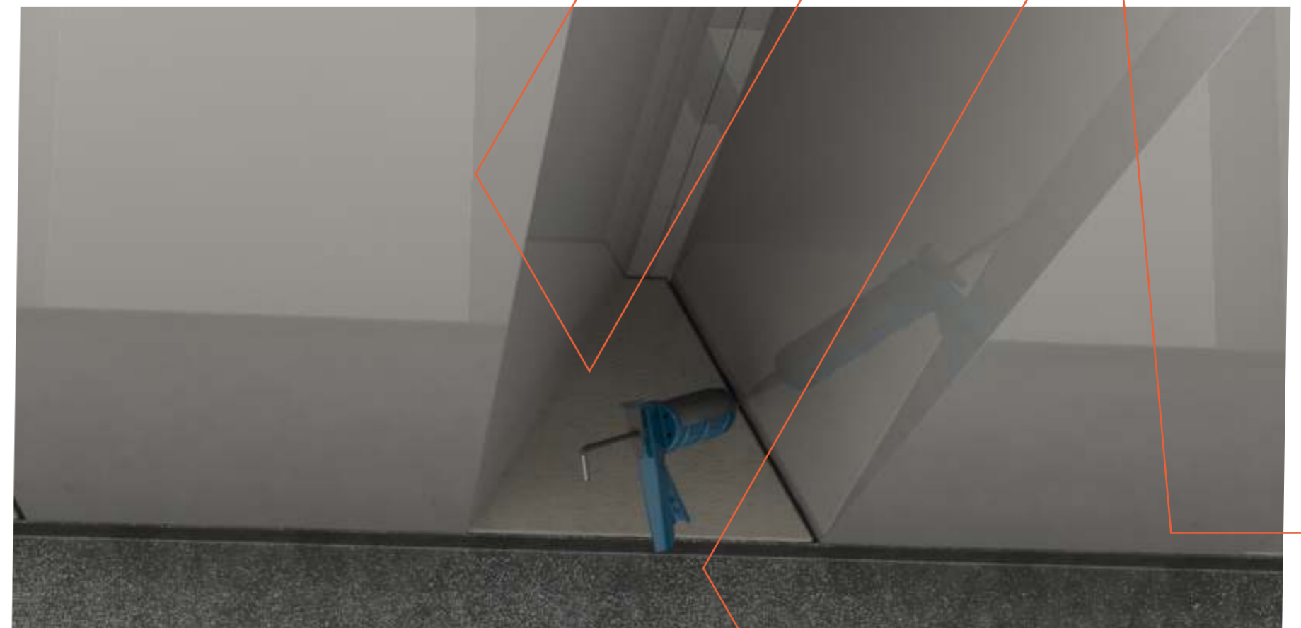
4- Los triángulos se colocan en posición vertical u horizontal, según sea la necesidad. siempre entre la viga y el panel.
